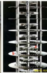
rotating-disk contactor a. agitator; b. stator disk
